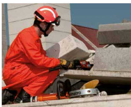
В паре с бетоноломом рекомендуется применять минирезак для арматуры CU 4007 С или SMC 4006 С.
